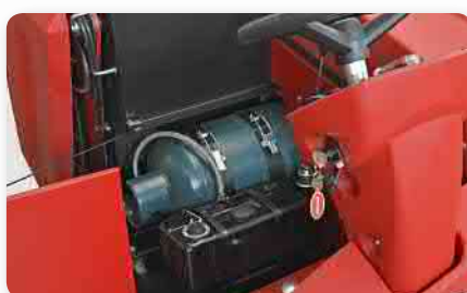
Impianto GPL LPG system Instalación de GLP
