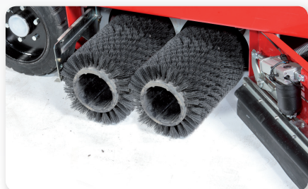
RULLI CONTROROTANTI CON ECCEZIONALE CAPACITA' DI SPAZZAMENTO E LAVAGGIO CONTEMPORANEO COUNTER-ROTATING ROLLER BRUSHES EXCEPTIONAL ABILITY TO SWEEP AND WASH CONTEMPORANEOUSLY
