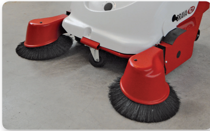
Braccio spazzola laterale sinistro Seitenbesenarm links Bras de la brosse latérale gauche
