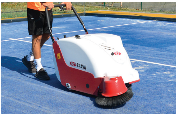
Spazzola centrale per la raccolta di sporco grossolano e dei filamenti di nylon delle palline. Con le sue setole "pettina" i filamenti di erba sintetica.
