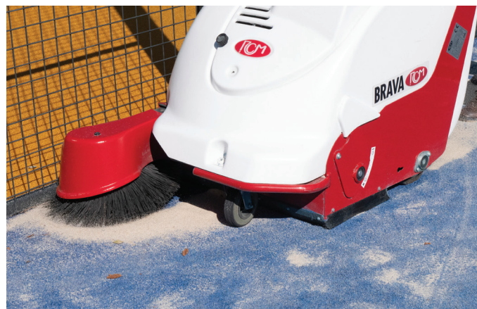
Spazzola laterale per la rimozione della sabbia a bordo campo.
