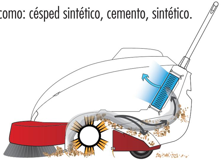
Filtros especiales para retener el polvo de silicio y el nylon de las pelotas.
